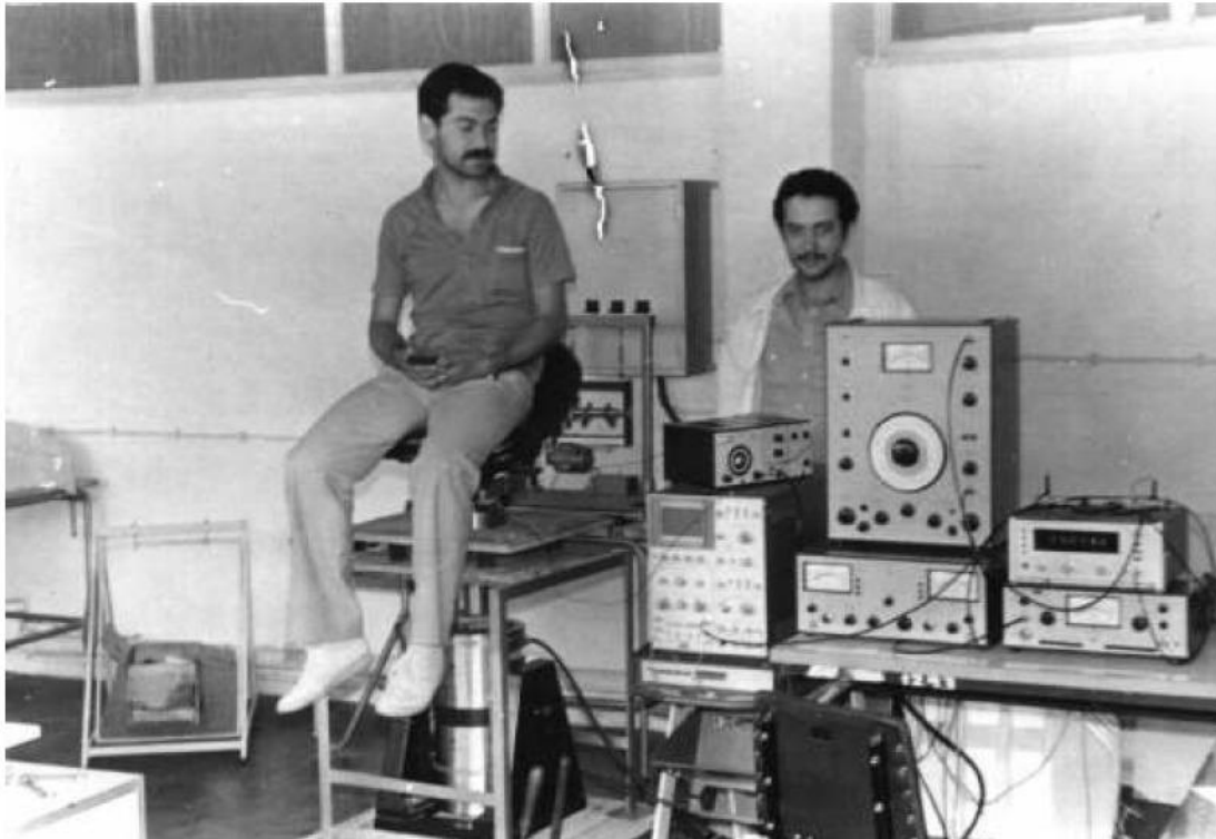
Titreşim Laboratuvarı traktör koltuğu (Başak 12) titreşim testi. Teknisyen Zafer Dicle
