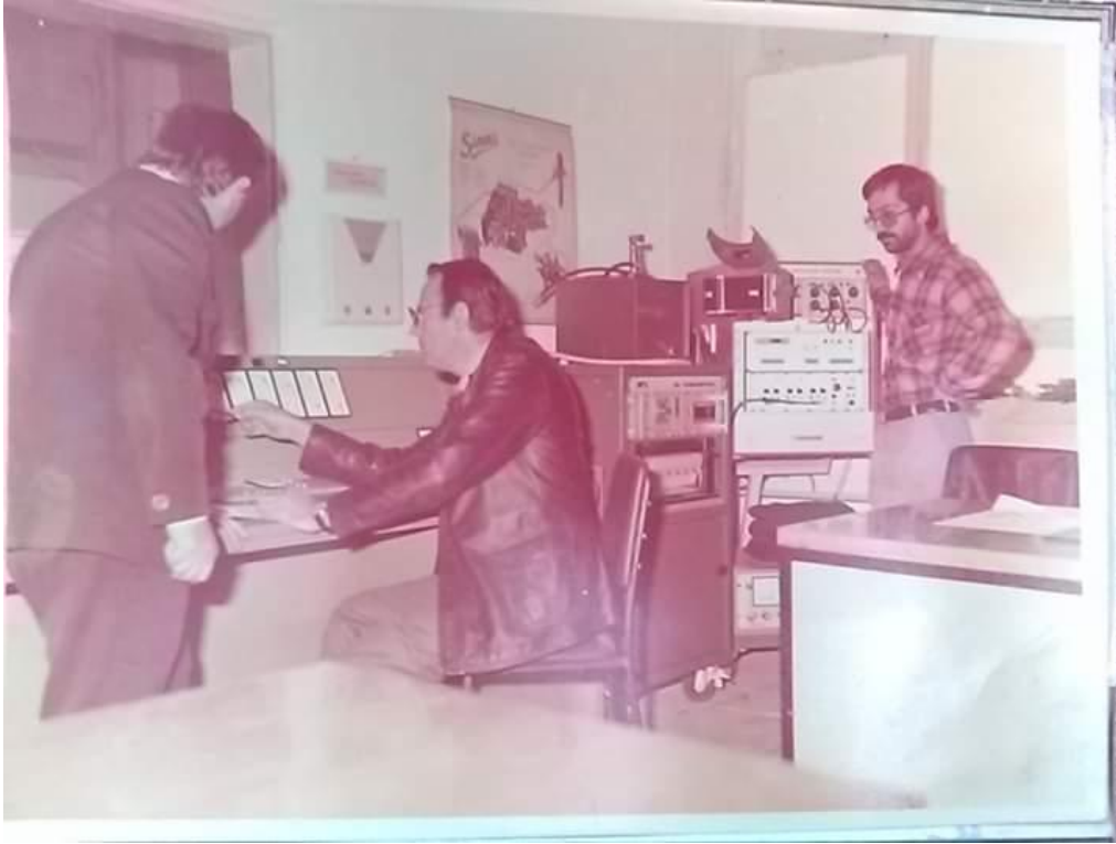
Titreşim Laboratuvarı traktör koltuğu (Başak 12) titreşim testi. Teknisyen Zafer Dicle
