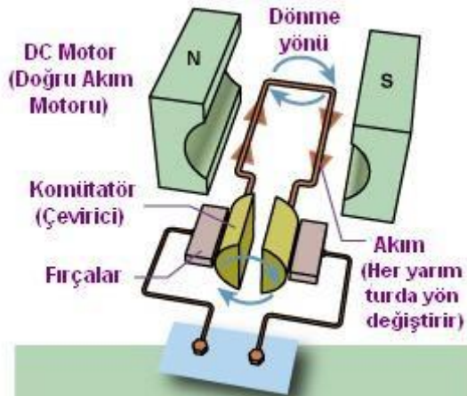
Şekil 2. DC Motor Çalışma Prensibi
