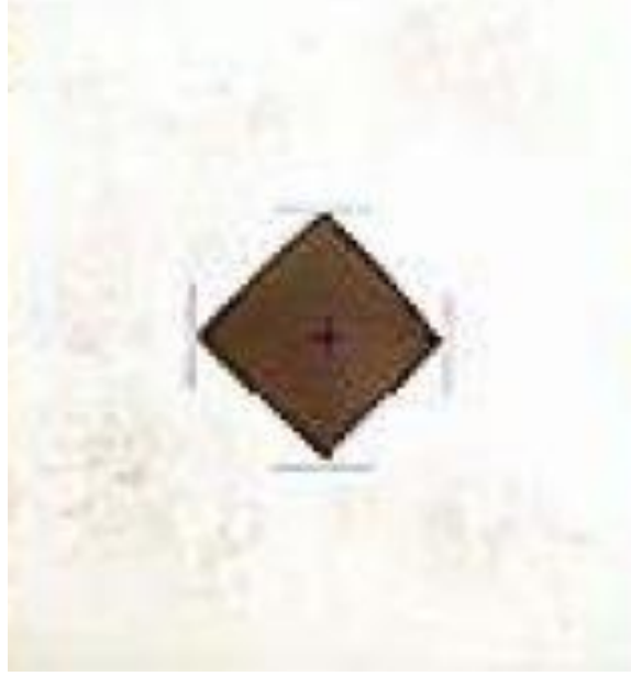
Yükten sonra numune üzerinde oluşan piramit ucun izi
